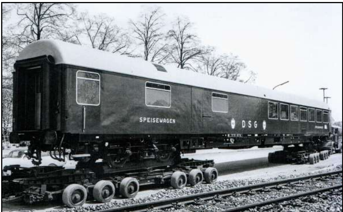
...oder Schnellzugwagen mit 2 Culemeyer-Straßenrollern, wie hier ein Speisewagen zur Ausstellung auf der IVA 1965 in München
