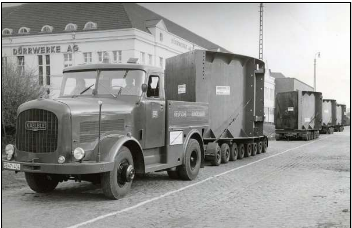
Kaelble KV 631 mit Culemeyer-Straßenroller (ca. 1954)
