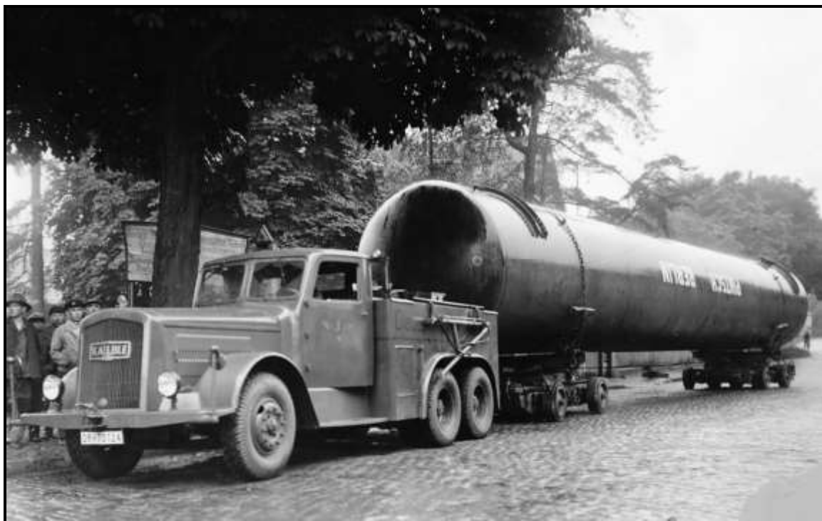
Kaelble Z6 R2A 100 mit Culemeyer-Straßenroller und verladenem Gasbehälter in Berlin (1938)
