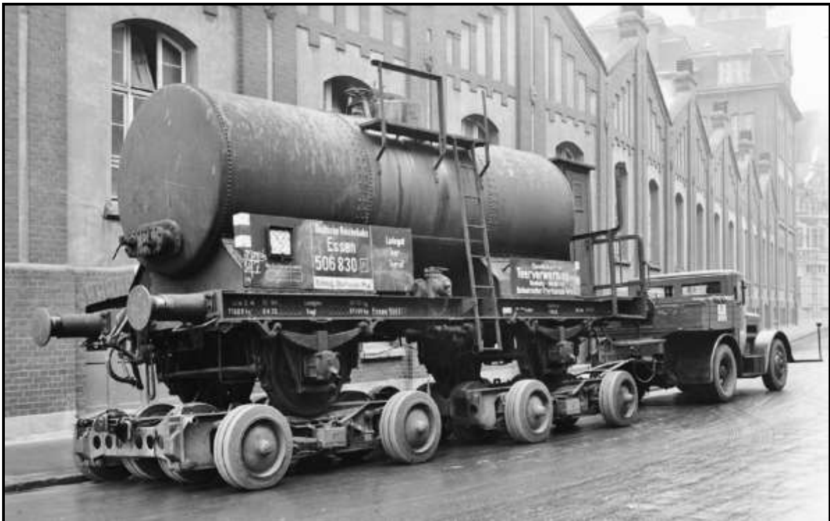
Kaelble Z 4 GR mit Culemeyer-Straßenroller und verlastetem Kesselwagen (1934)
