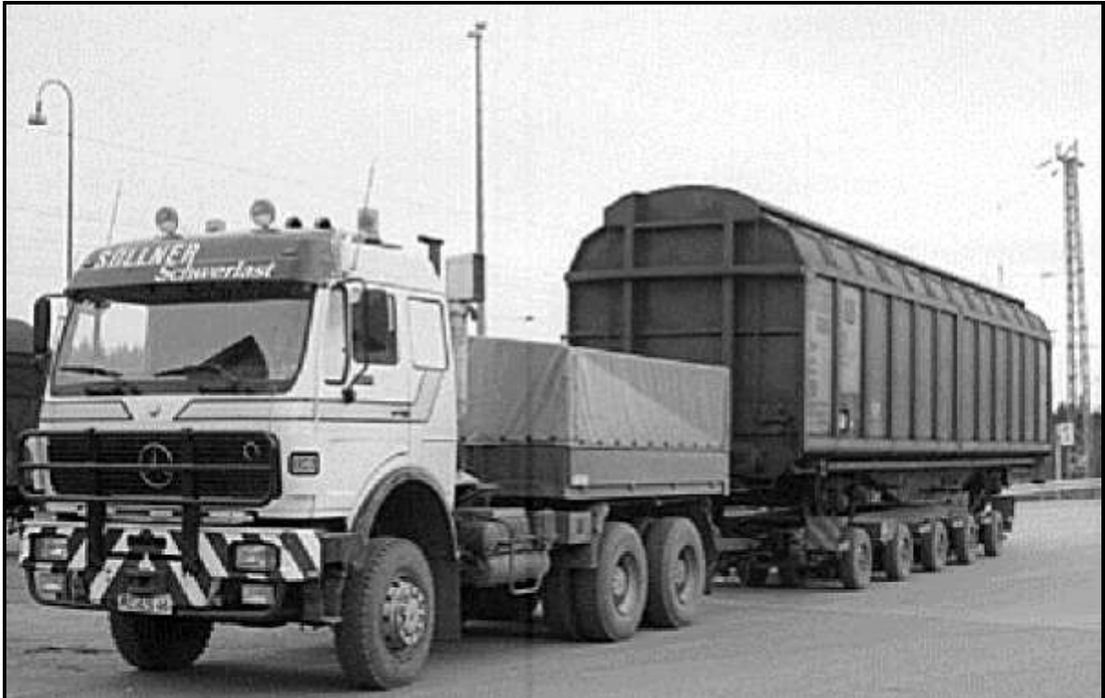
Mercedes-Benz NG 3850 Zugmaschine der Fa. Söllner mit Straßenroller und verladenem Güterwagen
