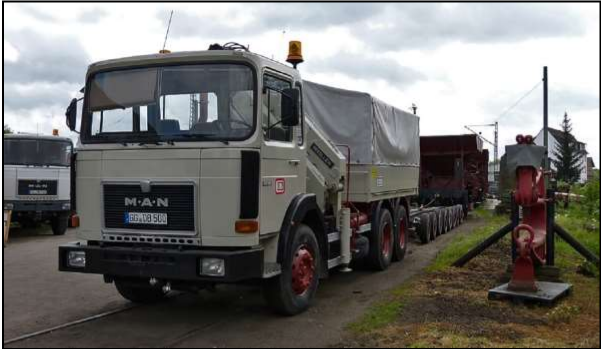
MAN 26.361 DFA mit Culemeyer-Straßenroller beim Verladen eines Güterwagens im Eisenbahnmuseum Darmstadt-Kranichstein
