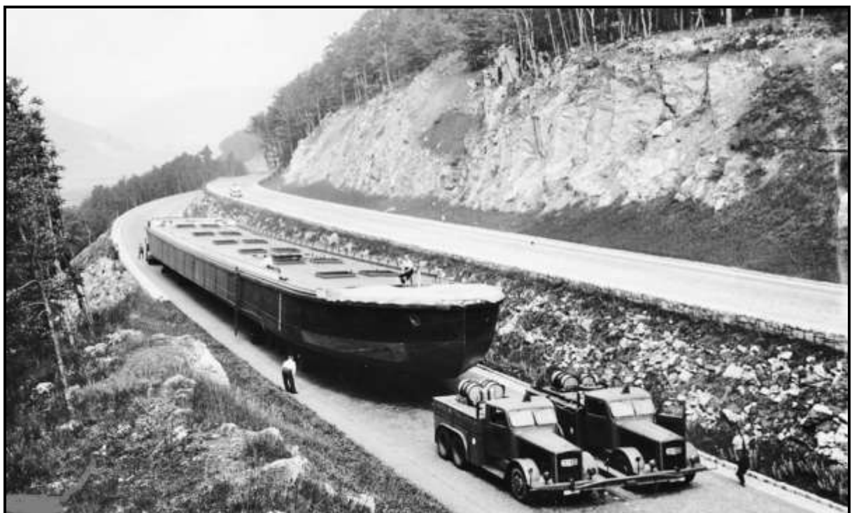
Schiffstransport mit Culemeyer-Fahrzeugen bei Hirschberg (27.05.1940)
