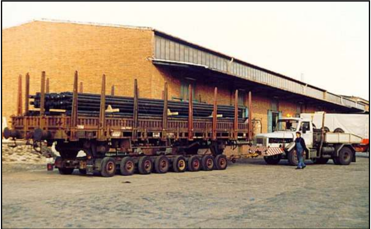
FAUN F 610-36 bei der Vorbereitung zum Abladen eines Rungenwagens
