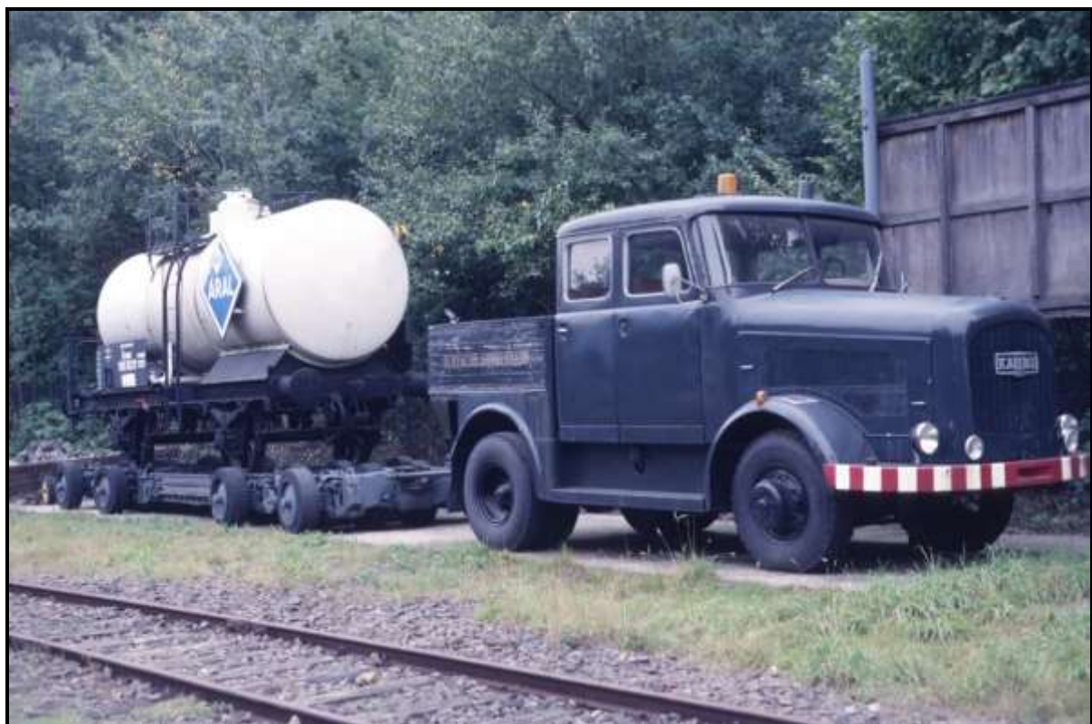
Kaelble KV 632 Doppelkabine mit Culemeyer-Straßenroller und verladenem Kesselwagen im Eisenbahn-Museum Bochum-Dahlhausen (ca. 1990)
