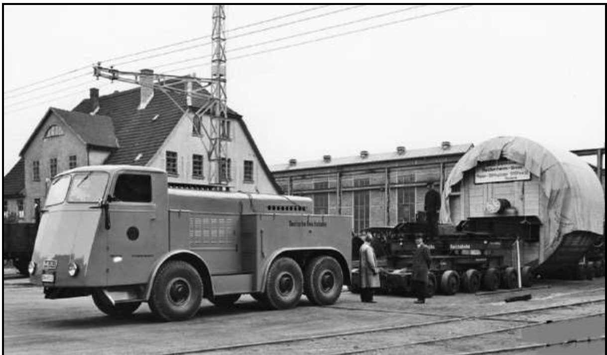
Kaelble Z6R - 3A Zugmaschine "Jumbo" mit Culemeyer-Straßenroller und weltgrößtem Zylinder in Heidenheim (Oktober 1937)
