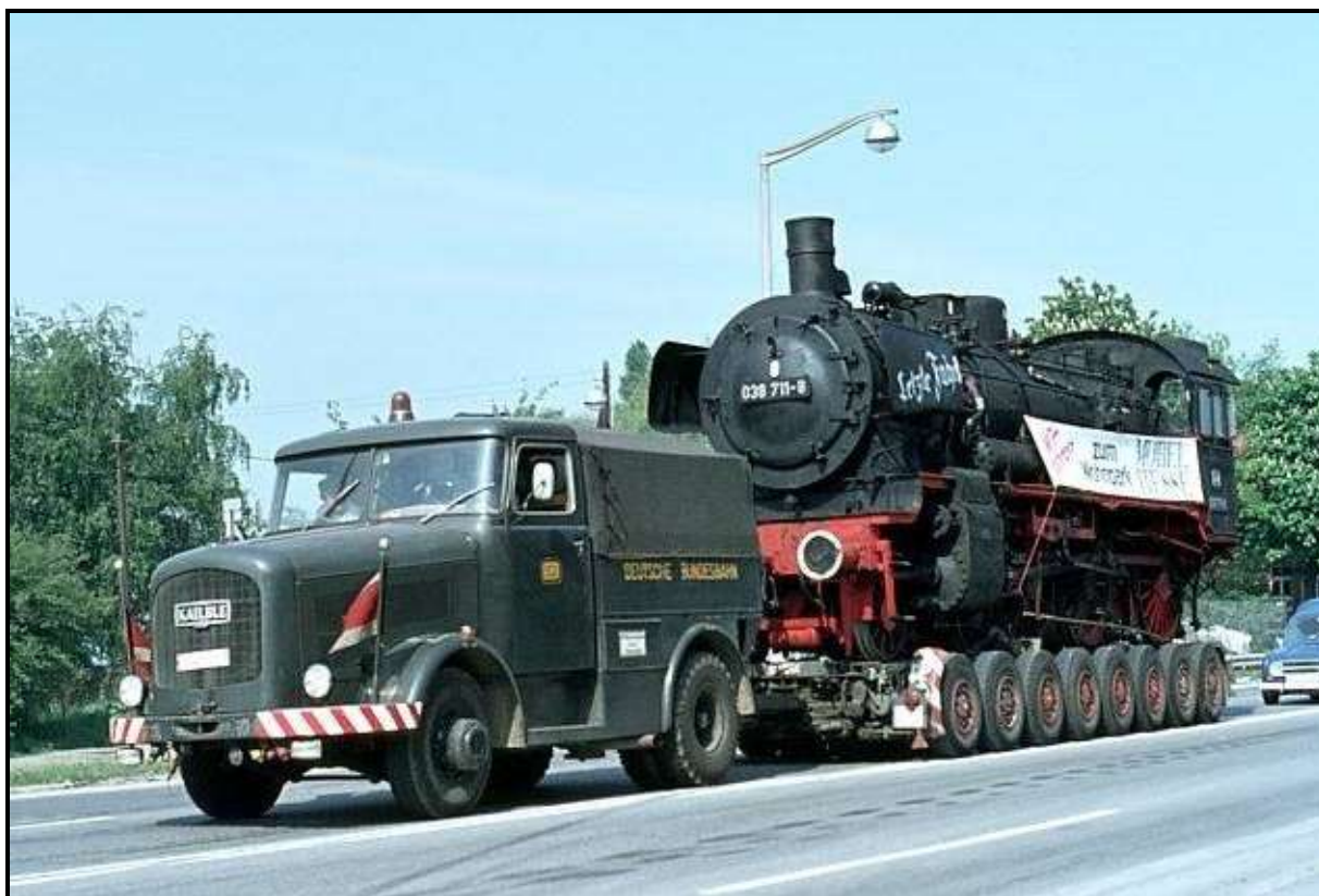
Kaelble KV 632 mit Culemeyer-Straßenroller und verladener Dampflok BR 38 711 (ca. 70 Tonnen) in Hannover-Langenhagen (16.05.1974)
