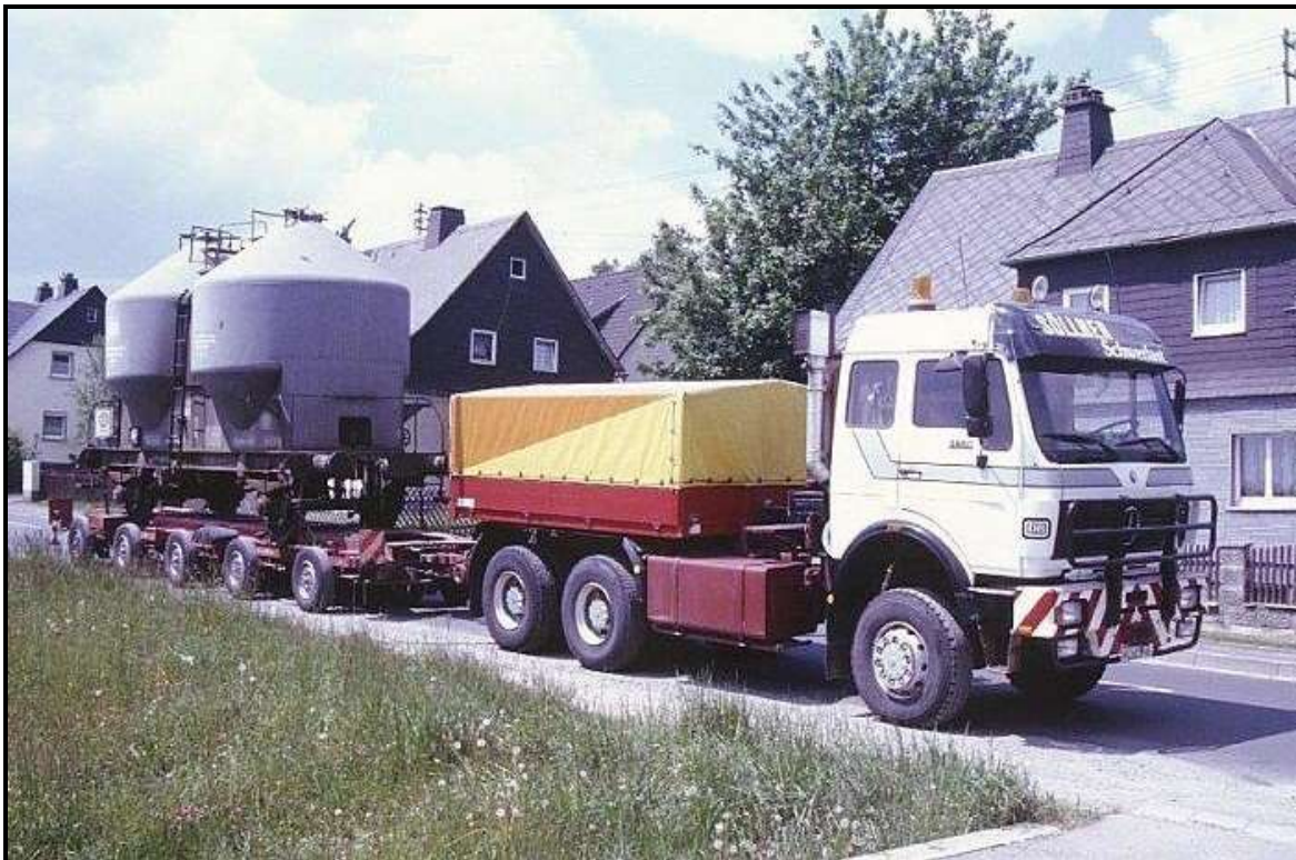
Mercedes-Benz NG 3850 Zugmaschine der Fa. Söllner beim Transport eines Güterwagens in Steinbach am Wald (Mai 1990). Der Straßentransport war dort erforderlich wegen des durch die Zonengrenze abgeschnittenen Gleisanschlusses einer privaten Firma
