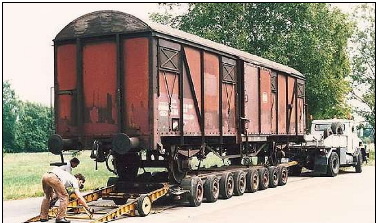
FAUN F 610-36 bei der Vorbereitung zum Abladen eines gedeckten Güterwagens
