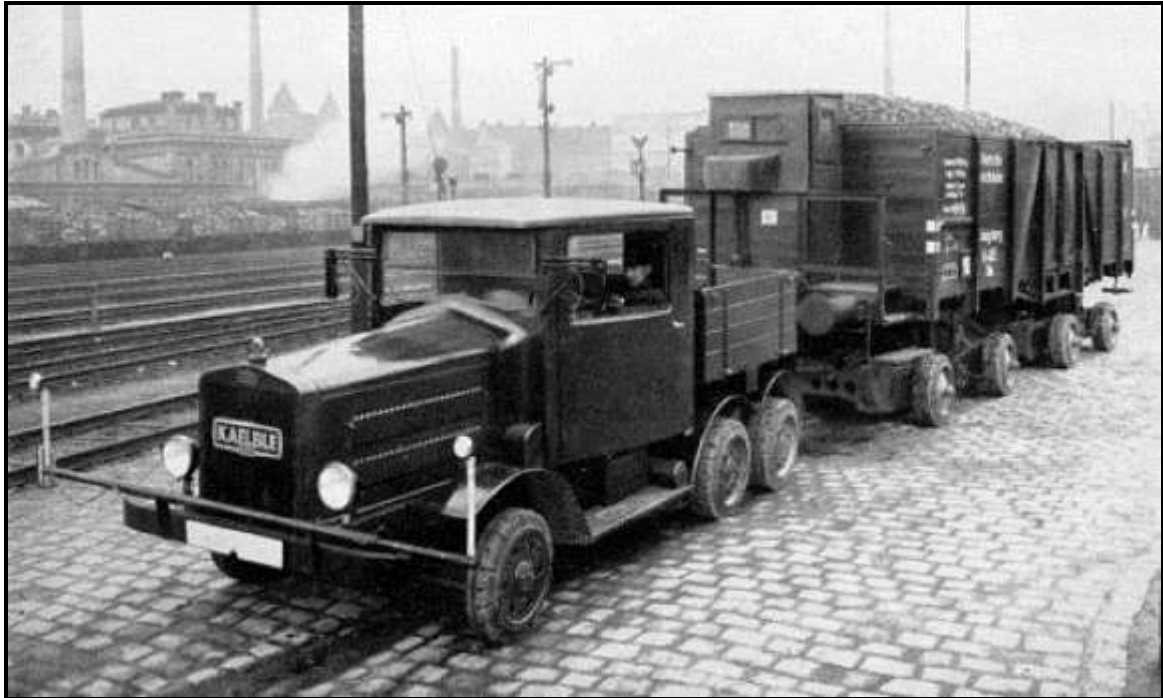
Kaelble Z6R mit Culemeyer und verlastetem Hochbord-Güterwagen
