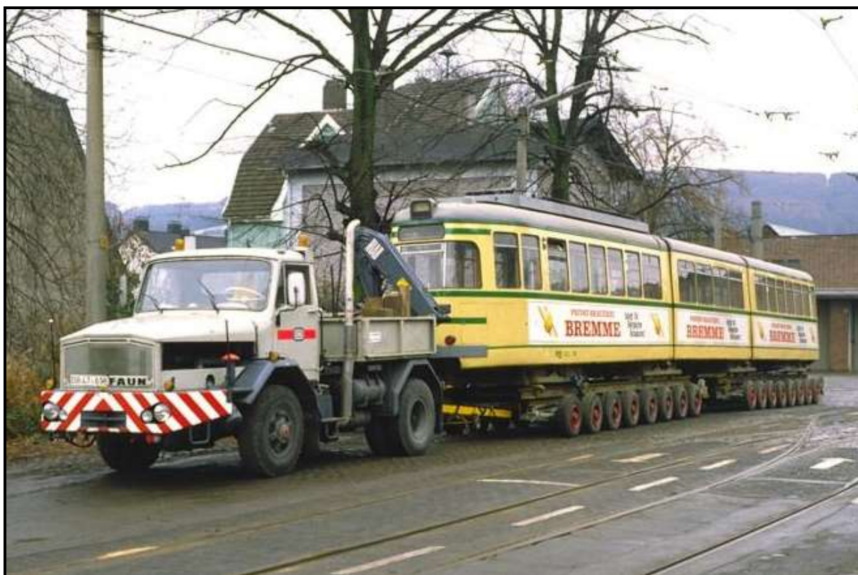
FAUN F 610-36 mit zwei achtsachsigen Culemeyer-Straßenrollern und verladenem Straßenbahn-Triebwagen in Recklinghausen (02.12.1985)
