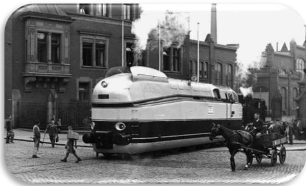
Am 31.05.1935 erfolgte die Übergabe der Lokomotive, welche damals anfangs für eine Höchstgeschwindigkeit von 175 km/h zugelassen war. Die Treibräder, welche über einen Durchmesser von 2.300 Millimetern verfügten, ermöglichten diese hohe Geschwindigkeit.
