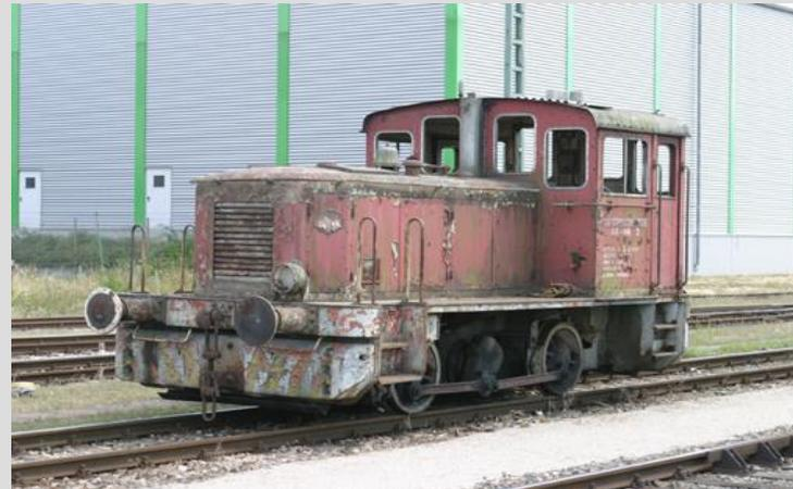
Bei dieser von der Luitpoldhütte, Amberg, übernommenen Lokomotive handelt es sich um eine mittelschwere Industriebahn-Bauart, die ausschließlich in Betrieben und bei der Bundeswehr eingesetzt war. Sie ist leistungsmäßig zwischen Köf und V40-1 anzusiedeln.
